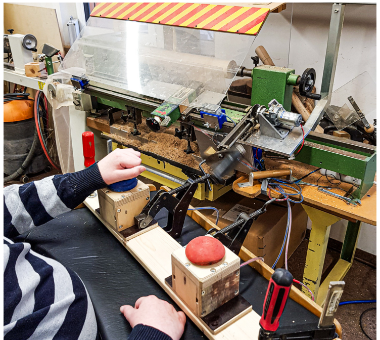
Bisher konnten viele Teilnehmende im MFZ Giesing an der Drehbank nur zusehen. Durch unsere gezielte Anpassung können nun auch Menschen mit starken Einschränkungen die Maschine aktiv bedienen.
